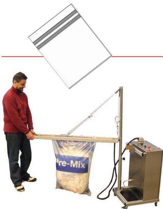
Saldatrice appositamente studiata per chiudere sacchi voluminosi o pesanti, anche posti all'interno di fusti o scatole, con un'impronta di **saldatura a binario (2 righe parallele)**.
